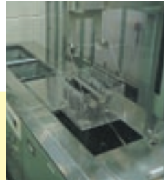
部品洗浄機 部品段階での油脂分を排除します。 Parts Cleaner
