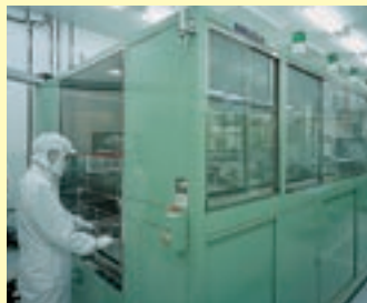
完成品洗浄機 出荷前に純水洗浄を行います。 Final Cleaner
