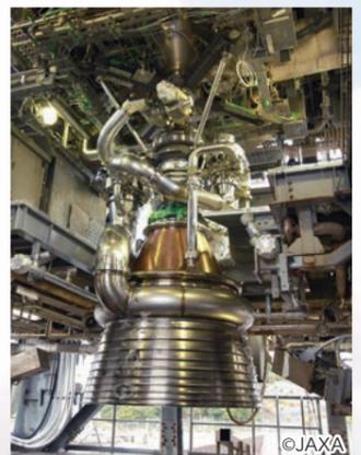
燃焼試験スタンドにセットされたLE-9エンジン
