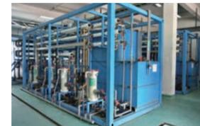
「化学(加圧浮上)+物理(膜浄化)」システム
