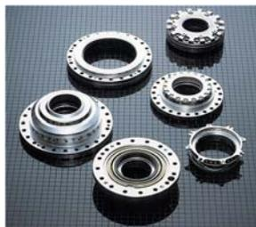
ロケットエンジン用ターボポンプシール。H-IIAロケットの第1段、第2段エンジンに採用され、極限条件下での高速回転軸において、流体の接触や漏洩を防ぐシールシステムを構成しています
