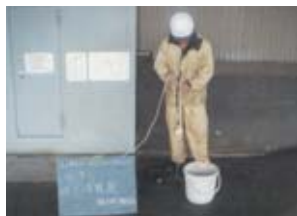
地下水調査（観測井戸のバージング）
