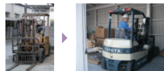
フォークリフトの電動化 (岡山事業場) 古くなったフォークリフトを電動型に更新し、CO 2 排出量を約6t/年削減しました。
