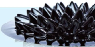
磁性流体シールとは、シャフト（回転軸）と磁石との間の磁力線に沿って磁性流体を保持し、シール膜（液体のOリング）が形成されることにより密封するシールで、半導体製造装置に使用されています。世界的な半導体需要に伴い、現在韓国では半導体製造装置市場の拡大が見込まれています。EKKグループのNEK Co., Ltd.（以下、NEK）は、韓国工場での磁性流体シールの現地生産をスタートさせました。そのような状況において、EKKグループは、世界的なIT技術の革新を担うべく、グローバルでの生産を推進していきます。
